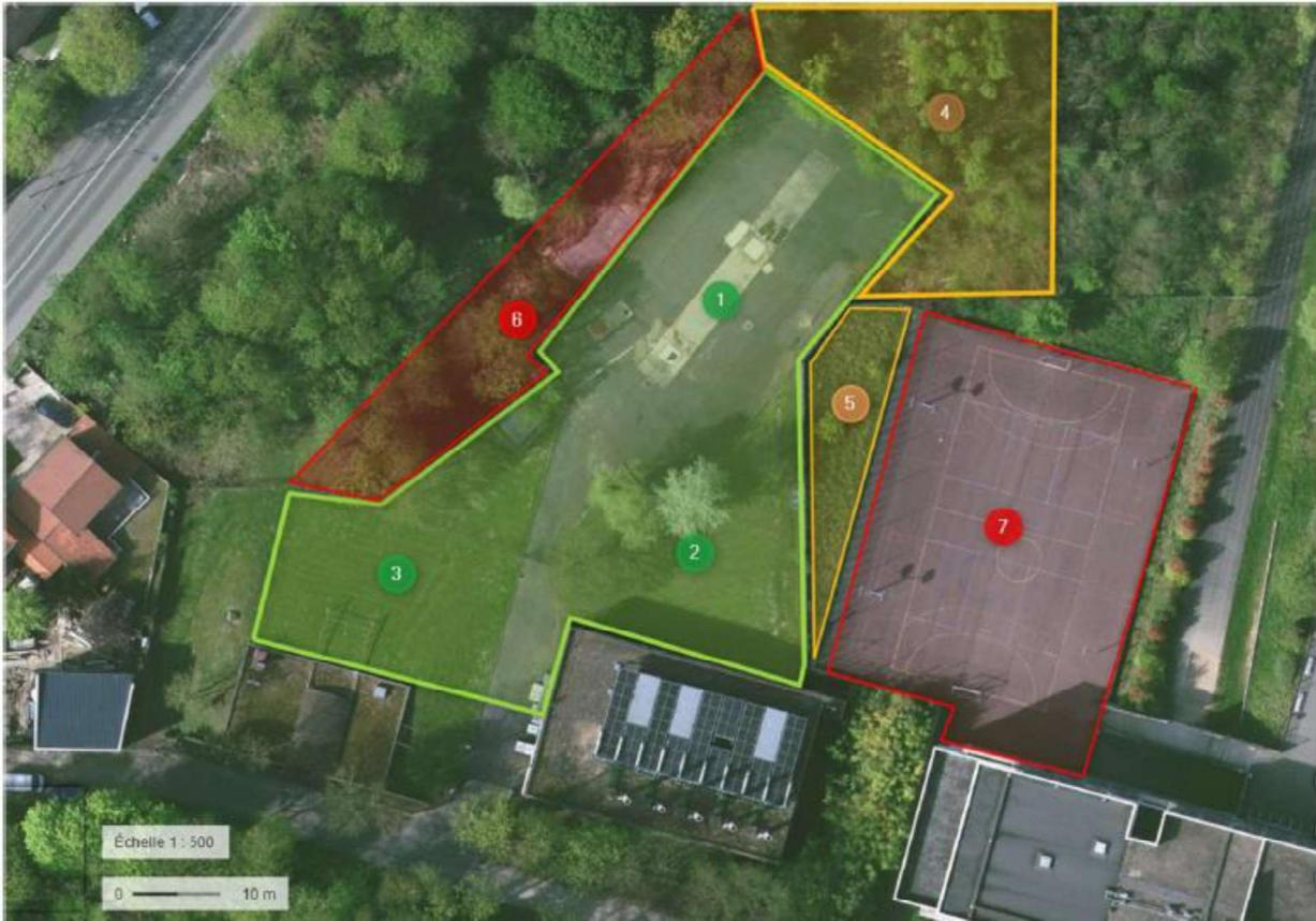
A partir de cette emprise, nous avons réalisé avec notre partenaire foreur 2gré une réflexion sur l'implantation du chantier forage et des têtes de puits en intégrant ces contraintes majeures.
